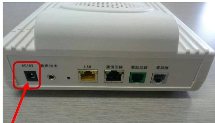
本体背面の電源を抜いて、数秒後に再度電源を挿してください。機器が再起動しランプが正常状態になったら、通話ができるか確認してください。
