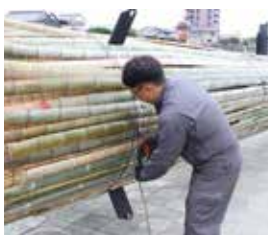
④番線（太い針金）でしっかり巻き付けて、たいまつ下部を完成させる。
