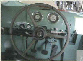
計器(メーター) もともと付いていたものを修理し、動きの悪い計器についてのみ現行品を別付け
