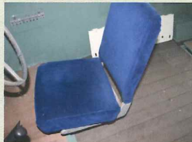
座席 温かみと懐かしさのあるモケット張りとし、前部は横向き、後部は前向きの配置
