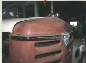
フロントバンパー等のメッキ ラジエーターキャップ、フロントエンブレムまわりのモール・飾り類、ヘッドライト・リム、スモールライト・リム、車幅ポール等にクロムメッキを施す
