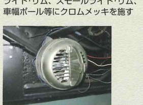
ヒーター 現在では製造されていないデンソー製の新品を取り付け
