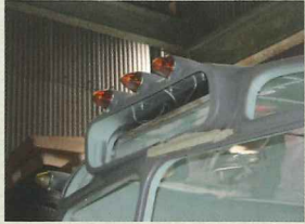
屋根灯(別称マーカーランプ、ロケット) 前部5個・後部2個のすべてを新材の鉄板により手作業で三次曲線に形づくる
