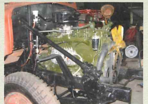
原動機(エンジン) もともと搭載されていたDA110が修理不能であったため、次型式のBX341のものと同型のDA120を整備し搭載
